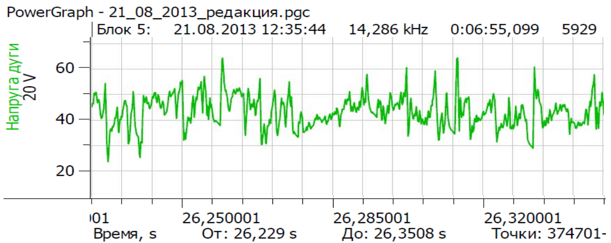
Рис. 2.8. Типові часові ряди значень напруги дуги: а - при нестабільному горінні; б, в – при стабільному горінні
