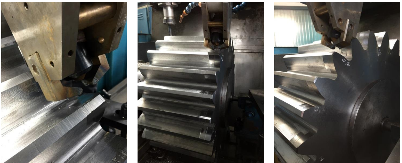
Рис. 16. Процес обробки вал-шестірни методом ППДЗ в умовах виробництва
