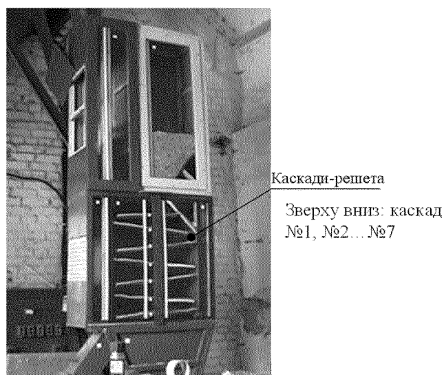
Рисунок 1 – Зовнішній вигляд експериментальної ЗСУ з киплячим шаром
