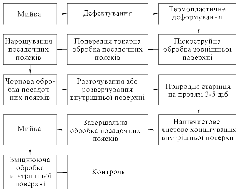
Рисунок 1 – Схема технологічного процесу відновлення гільз циліндрів методом термопластичного деформування
