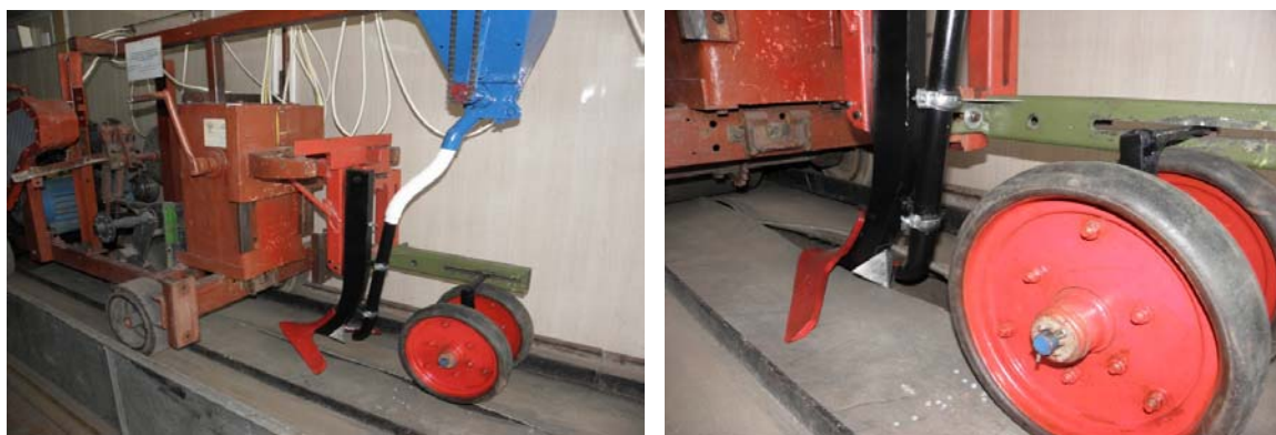
Рисунок 2 – Загальний вигляд експериментальної установки в ґрунтовому каналі
