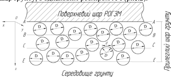
Рисунок 2 – Схема взаємодії поверхневого шару РОГЗМ і АЧ прилеглого шару ґрунту
