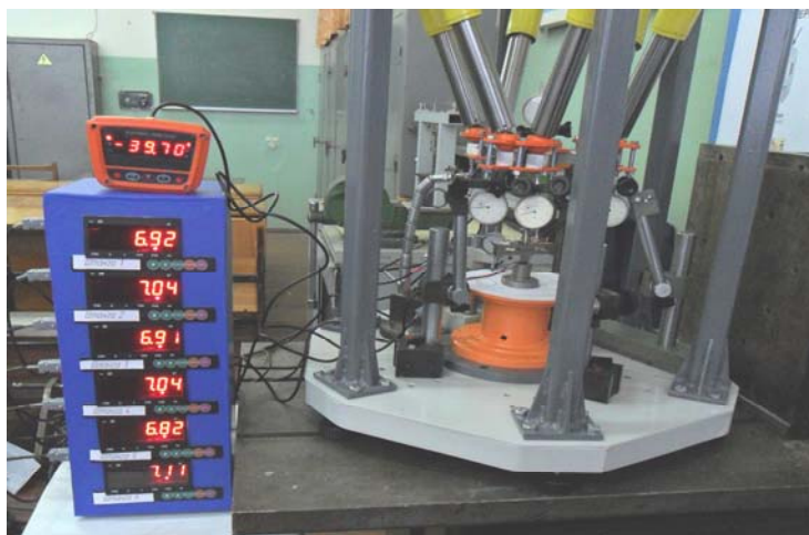
Рисунок 3 – Навантаження в максимально видовженому положенні при компоновці (3 \times 2) \times (3 \times 2) .
