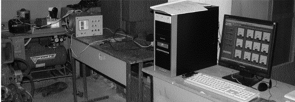
Рисунок 5 - Загальний вид автоматичного випробувального комплексу дослідження роботи основних сполучень ДВЗ
