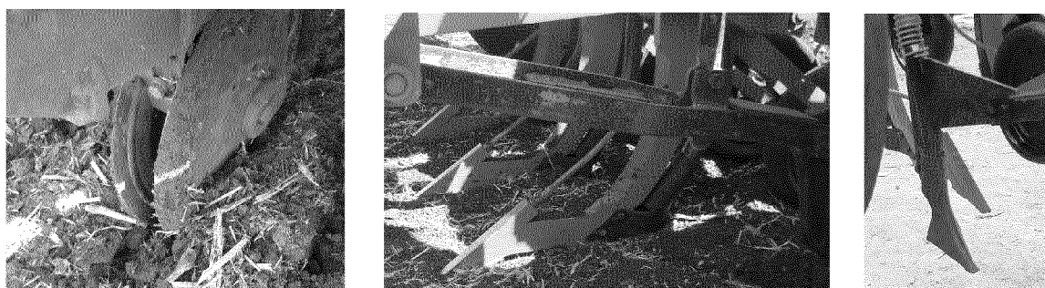
Рисунок 3 – Загальний вигляд та схема встановлення сошників на глибину сівби
