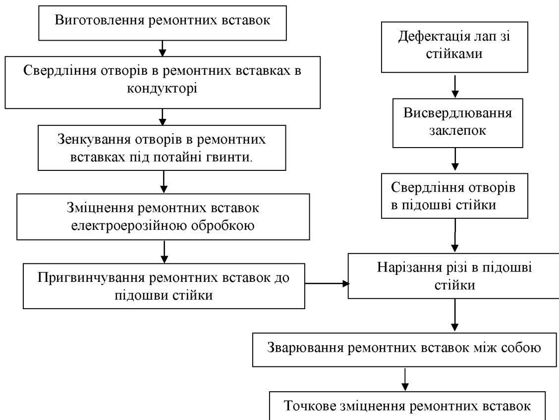
Рисунок 2 – Схема технологічного процесу відновлення лап культиваторів
