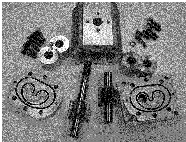
Рисунок 2 - Фотографии деталей экспериментального насоса НШ-20 (32) УУРОН и элементов его качающего узла в сборе
