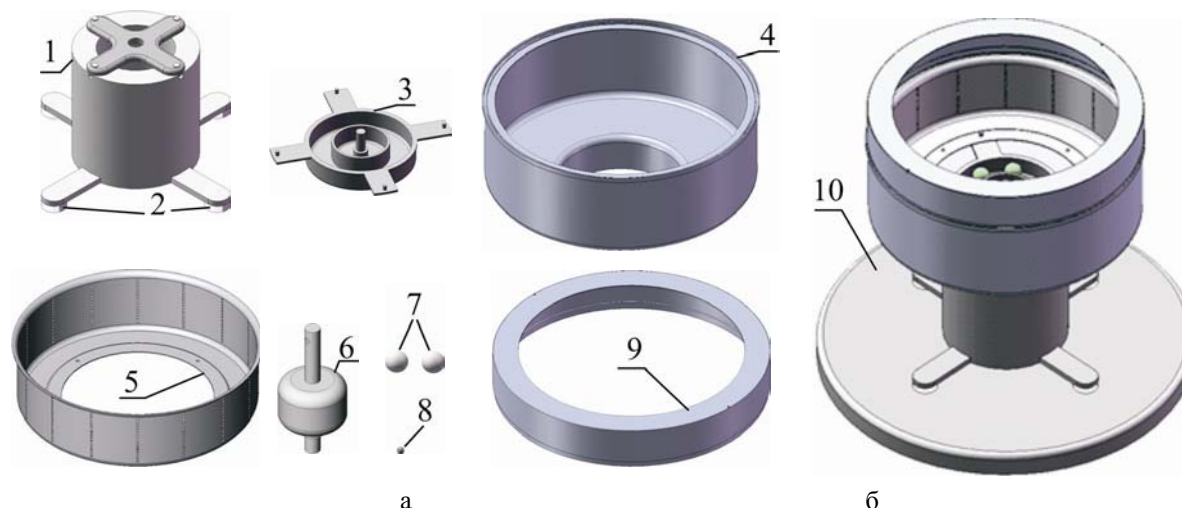
а – 3D модели основных деталей соковыжималки и автобалансира; б – объединение деталей в сборку
