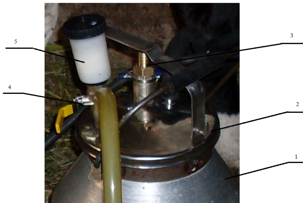
1 – доїльне відро, 2 – кришка, 3 – рідинний шаровий вентиль, 4 – повітряний шаровий вентиль, 5 – повітряний фільтр
