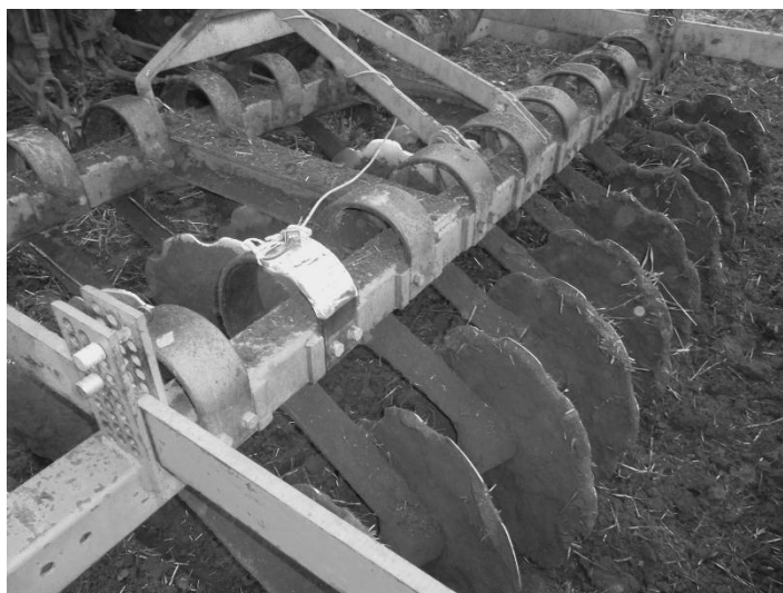
Рисунок 2 – Пружна ланка на дискаторі під час польових випробувань
