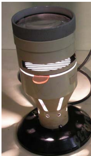
Рисунок 4 - Диафаноскоп для определения количества травмированных бобов после обмолота
