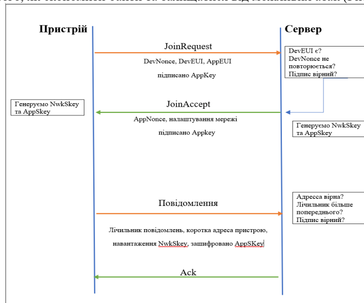
Рис. 1 Обмін повідомленнями в мережі LoRaWAN між сервером і пристроєм
