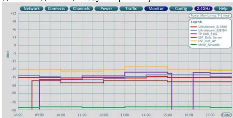
Рисунок 4 – Рівні потужності випромінювання WI-FI трансіверів та вузлів mesh-мережі
