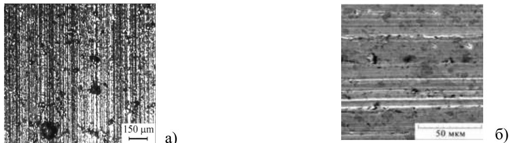
Рисунок 5. – Поверхні тертя після випробувань закріпленим абразивом покриття опорних шийок а) та кулачків б) розподільчих валів
