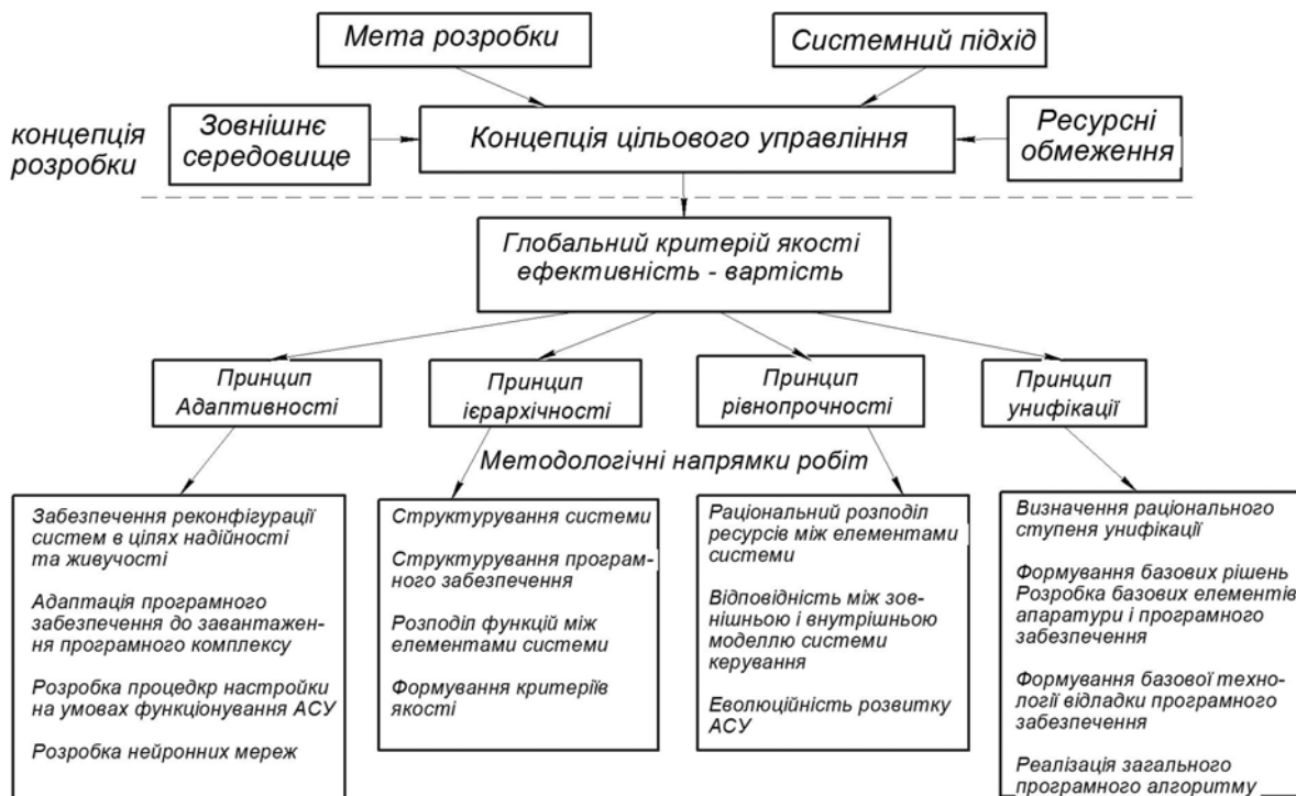
Рисунок 1. – Методологія проектування складних АСУ (БОС)
