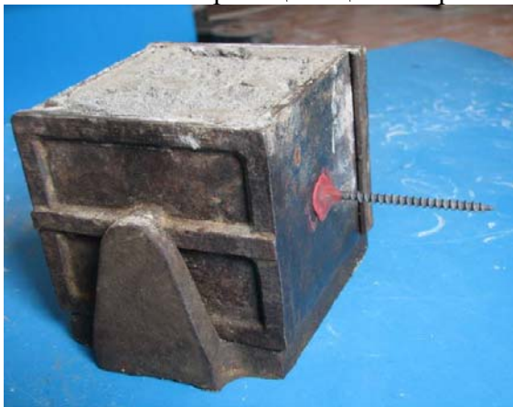
Рисунок 1 – Виготовлений зразок з анкером
