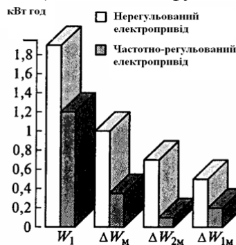
Рисунок 2 – Діаграми, що характеризують споживання енергії електроприводом ліфта.
