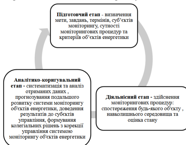
Рисунок 2 – Циклічна схема системи моніторингу об'єктів енергетики.
