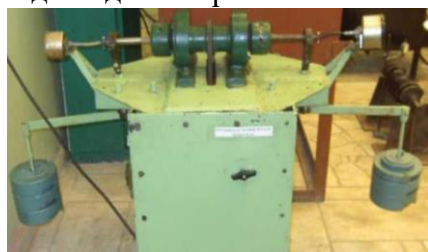
Рисунок 1 - Установка для втомних випробувань циліндричних зразків типу «вал» У-20
