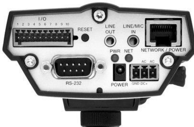
Рисунок 2 - Задня стінка відеокамери з доступними інтерфейсами взаємодії застосовувана при реалізації дипломного проекту
