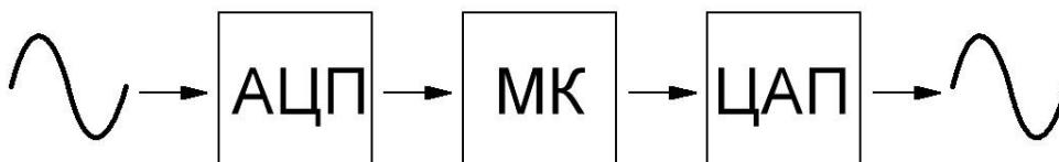
Рис. 4. Функціональна схема модуля з аналоговим вводом та виводом
