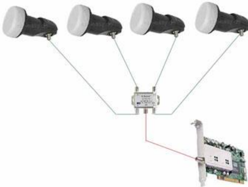
Рисунок 3 – Підключення чотирьох дорогих конверторні головки із дзеркалом на різні супутники
