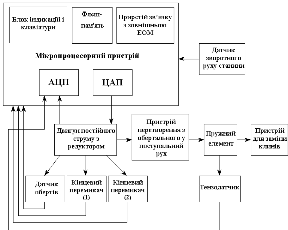
Рисунок 3 - Структурна схема модернізованого приладу для визначення фізико-механічних властивостей ґрунту
