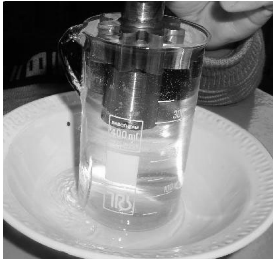
Рисунок 3 – Визначення об'єму шестерні, що досліджується шляхом визначення об'єму рідини, який витискається з мірної ємності при зануренні
