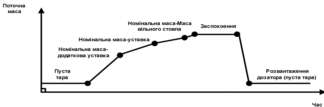
Рисунок 1 - Динамічні навантаження в часі на ваговимірювальну систему одного дозатора
