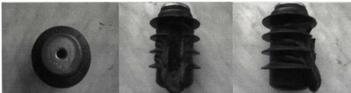
Рисунок 2 – Характерний вид термічного руйнування ОПН у режимі однофазного замикання на землю
