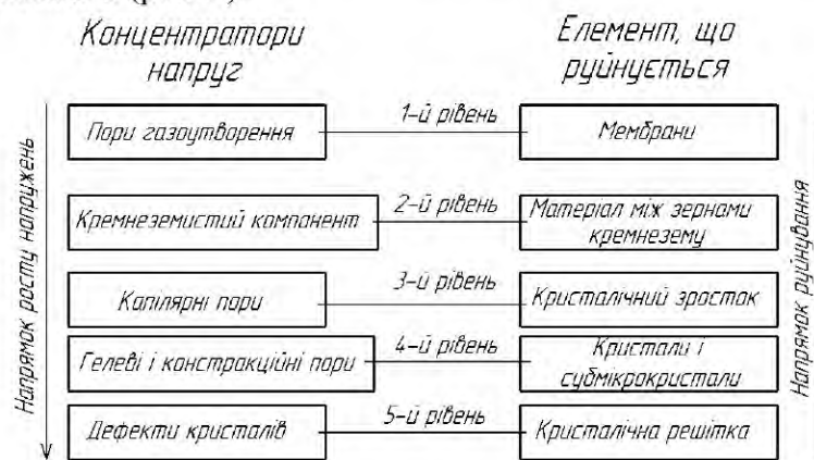
Рисунок 2 – Схема руйнування пінобетону
