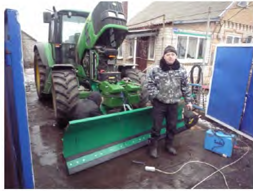
Рисунок 6 – Процес монтажу снігоприбирального відвалу власної конструкції
