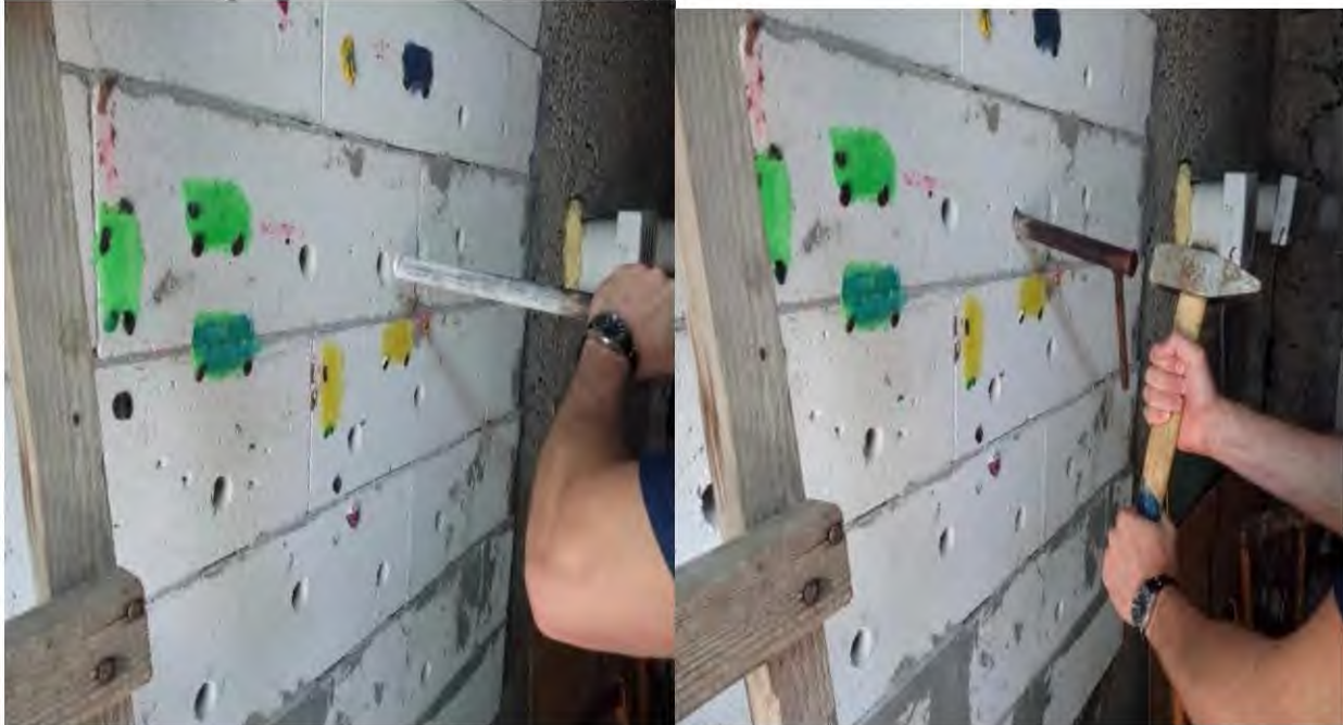
Рисунок 2 – Відбір проб матеріалу
