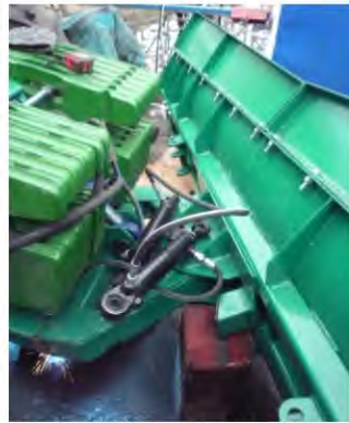
Рисунок 5 – Встановлення гідроциліндрів підйому-опускання та повороту відвалу в проміжку між секціями противаг
