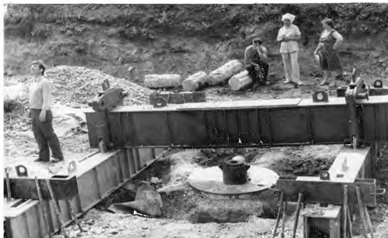
Рисунок 2 – Загальний вигляд станда для дослідження процесу виштампування заглиблень.
