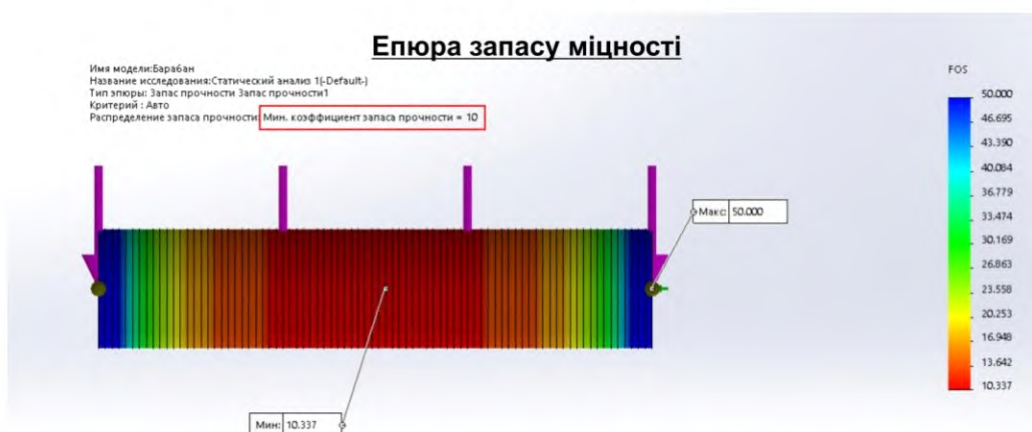
Рисунок 7 - Визначення запасу міцності барабана трубного млина
