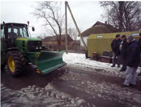
Рисунок 7 - Загальний вигляд колісного трактора John Deere 6930 з пропонованим універсальним бульдозерним робочим обладнанням під час натурних випробувань
