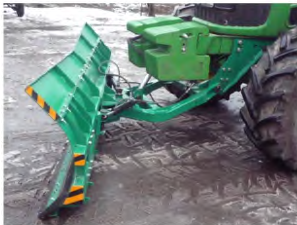
Рисунок 7 - Загальний вигляд колісного трактора John Deere 6930 з пропонованим універсальним бульдозерним робочим обладнанням під час натурних випробувань
