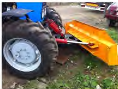
Рисунок 1 - Типові конструкції відвалів, що мають можливість встановлення під кутом до напрямку руху базової машини
