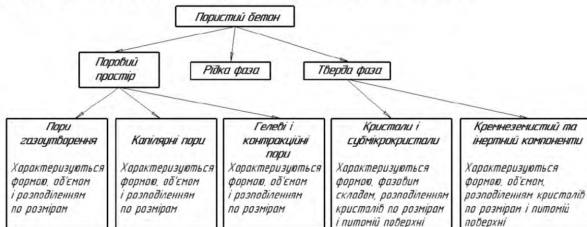
Рисунок 1 – Структура пористого бетону
