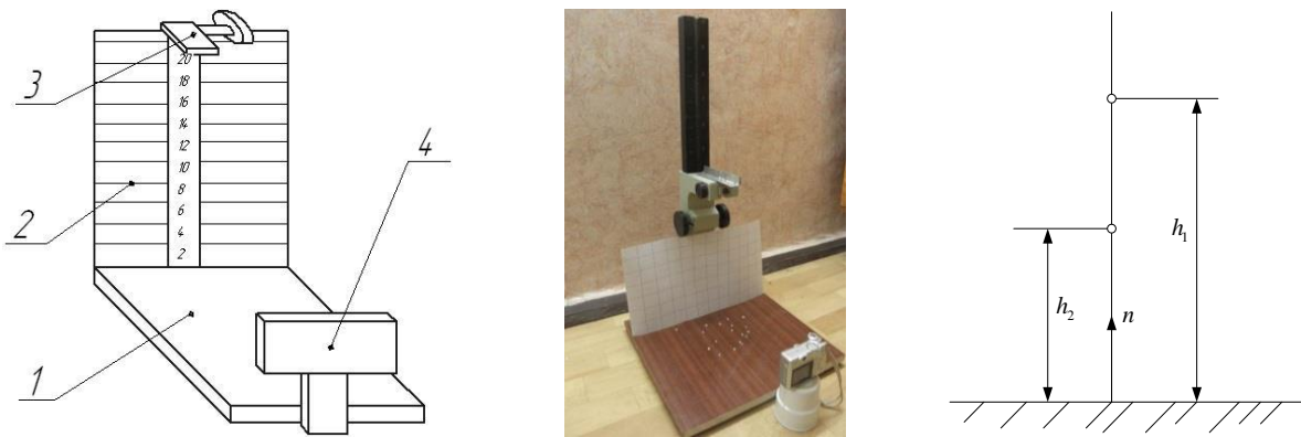
Рис. 1. Лабораторна установка для визначення коефіцієнту відновлення: 1 – стаціонарна стальна основа; 2 – вертикальна дошка з міліметровим папером; 3 – напрямна рейка; 4 – цифрова відеокамера
