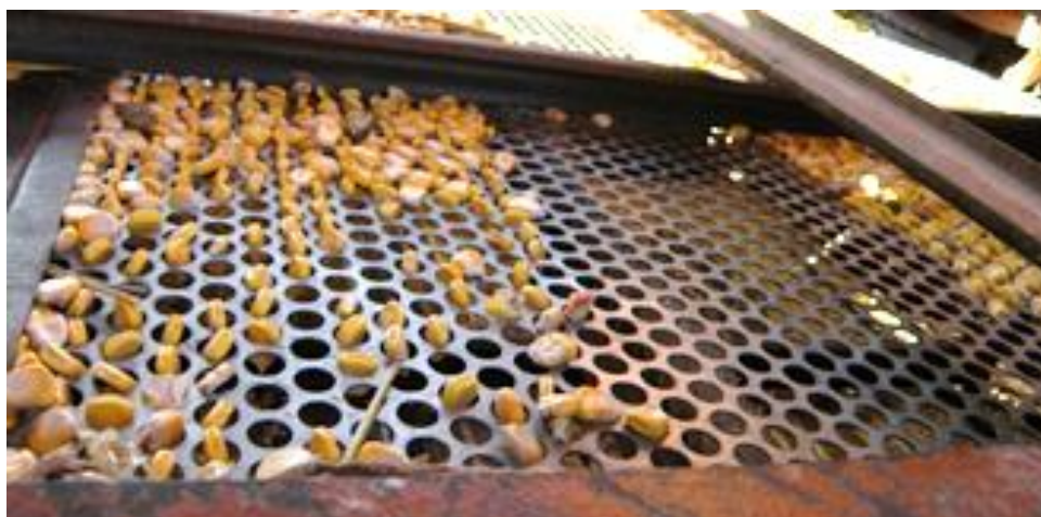
Рис. 1 Пропуски в зношених механізмах очищення решіт від забивань
