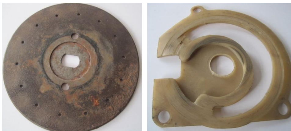
Рис. 1. Высевающий диск (а) с прокладкой (б) высевающего аппарата Н 126.13.000 сеялок типа СУПН
