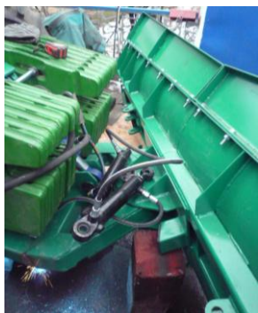
Рисунок 1 – Встановлення гідроциліндру підйому-опускання відвалу в проміжку між секціями противаг.
