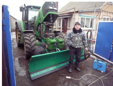
Рисунок 2 – Процес монтажу снігоприбирального відвалу власної конструкції та виготовлення.
