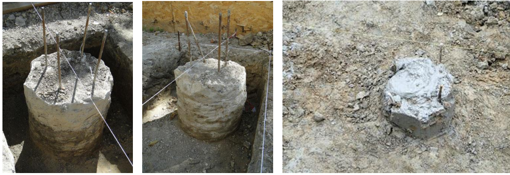
Рисунок 1 – Натурні зразки ґрунтоцементних елементів (ГЦЕ) (паль), отриманих за бурозмішувальною технологією.
